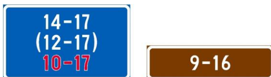
Kuva 18. Lisäkilpi (H17): voimassaoloaika (H17.1 arkipäivä maanantaista perjantaihin, H17.2 arkilauantai ja H17.3 sunnuntai, itsenäisyyspäivä, vapunpäivä tai kirkollinen juhlapäivä). Kellonajan punainen väri ei vaihdu lisäkilven pohjavärin mukaan.
